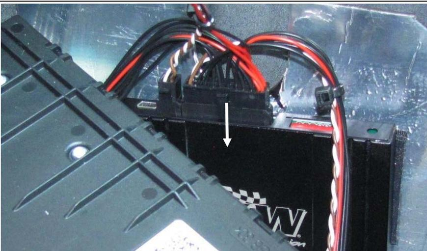
Die vom Kabelbaum abgehenden Stecker (20-polig und 4-polig) in das KW DLC Steuergerät einstecken. Steuergerät mittels Klettband am Original Steuergerät befestigen.
