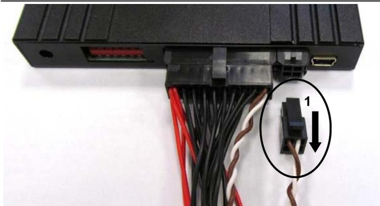
Markierter Stecker (1) ausstecken und den mitgelieferten Y-Adapter dazwischen stecken. Anschließend den 4-poligen Stecker (1) in den Y-Adapter einstecken.
