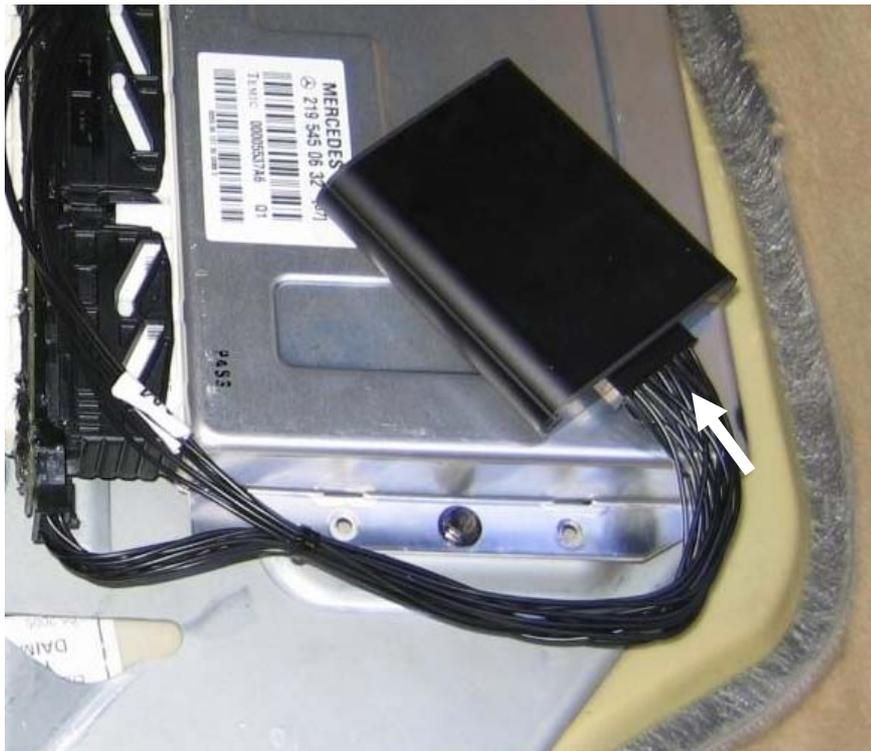
Die vom Kabelbaum abgehenden Stecker (20-polig und 4-polig) in das KW DLC Steuergerät einstecken. Steuergerät mittels Klettband am Original Steuergerät befestigen.
