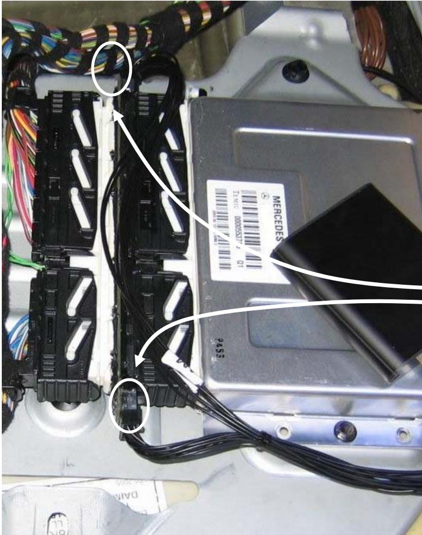
Mitgelieferten Kabelsatz an den DLC Adapter anschließen.
