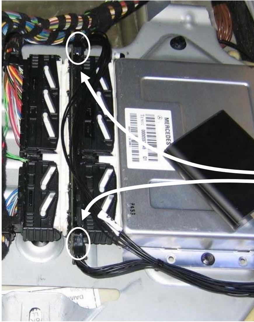
Mitgelieferten Kabelsatz an den DLC Adapter anschließen.
