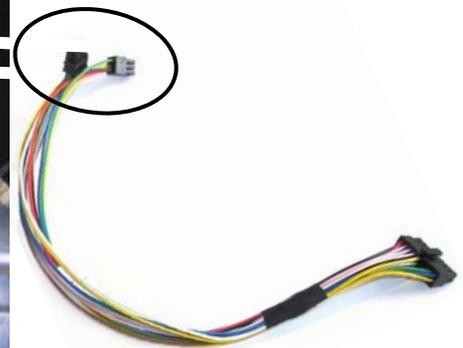
Mitgelieferter Adapter (Aufdruck Art. Nr. **67090033**) in die Leitung „WIFI“ einstecken. Dieser Adapter wird für die Montage eines WLAN Moduls benötigt.
