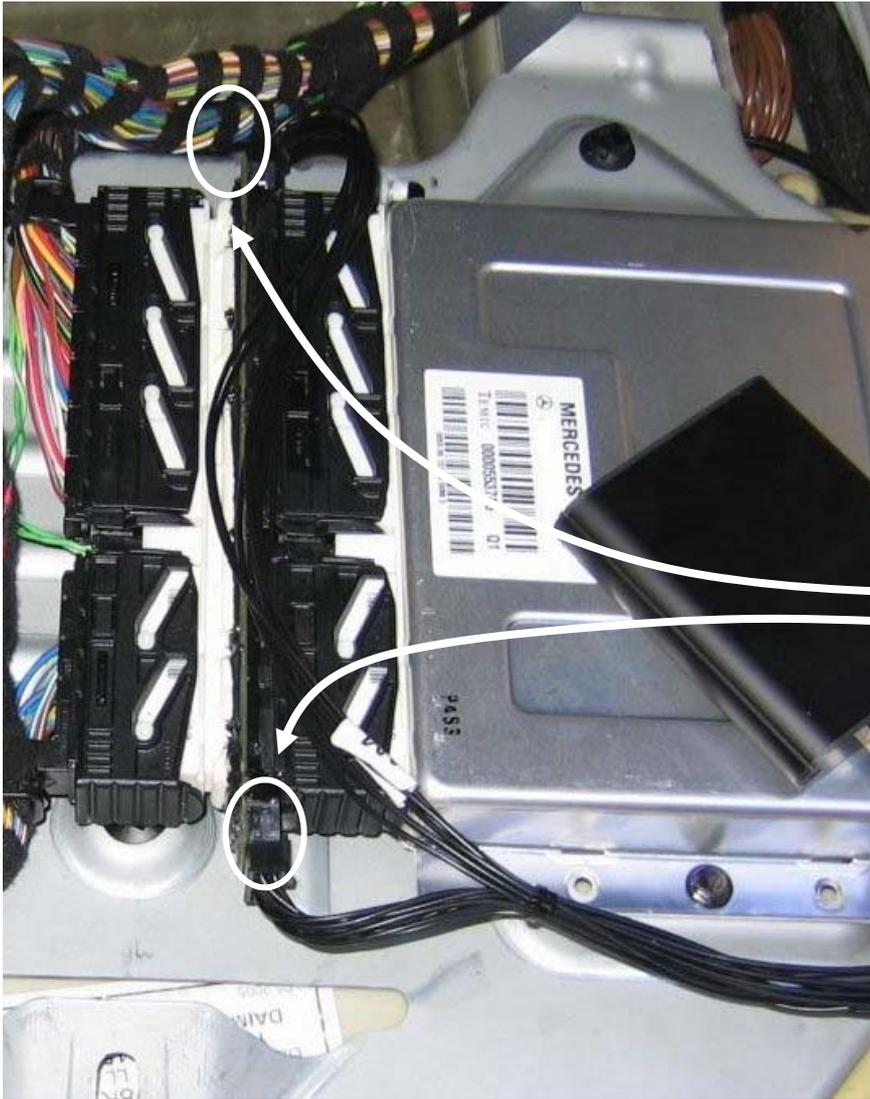
Mitgelieferten Kabelsatz an den DLC Adapter anschließen.
