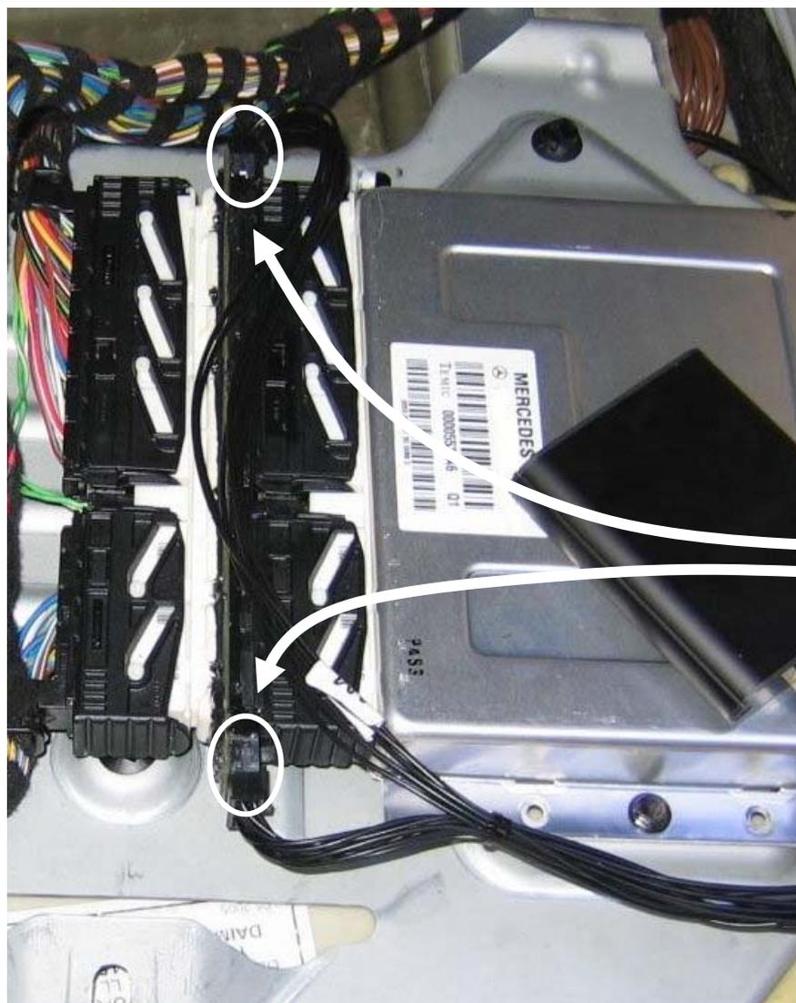
Mitgelieferten Kabelsatz an den DLC Adapter anschließen.
