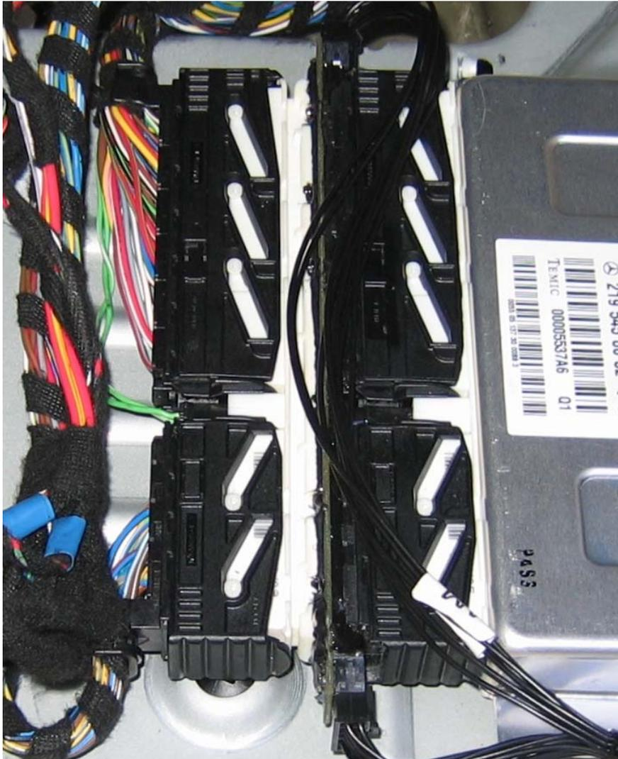
Mitgelieferten DLC Adapter zwischen Original Steuergerät und Original Kabelbaum stecken.
