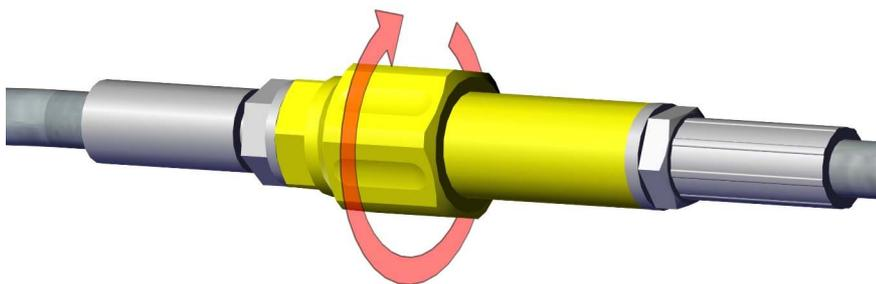
Anzugsdrehmoment der Schraubverbindung beträgt 15Nm.
