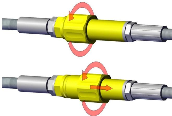
**Überwurfmutter lösen und herunterdrehen**
