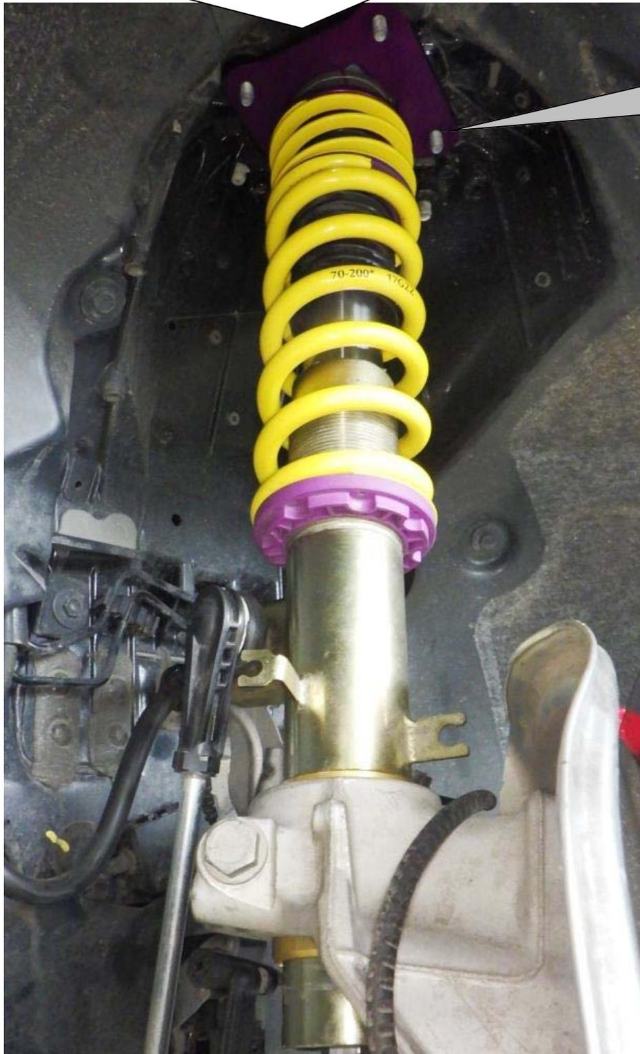
**Das Anzugsdrehmoment der Domlagerschrauben beträgt 25 Nm.**
