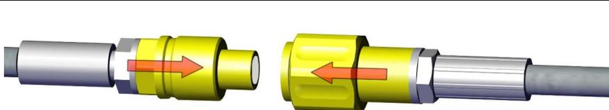
Kupplung zusammenstecken und mit der Überwurfmutter sichern.
