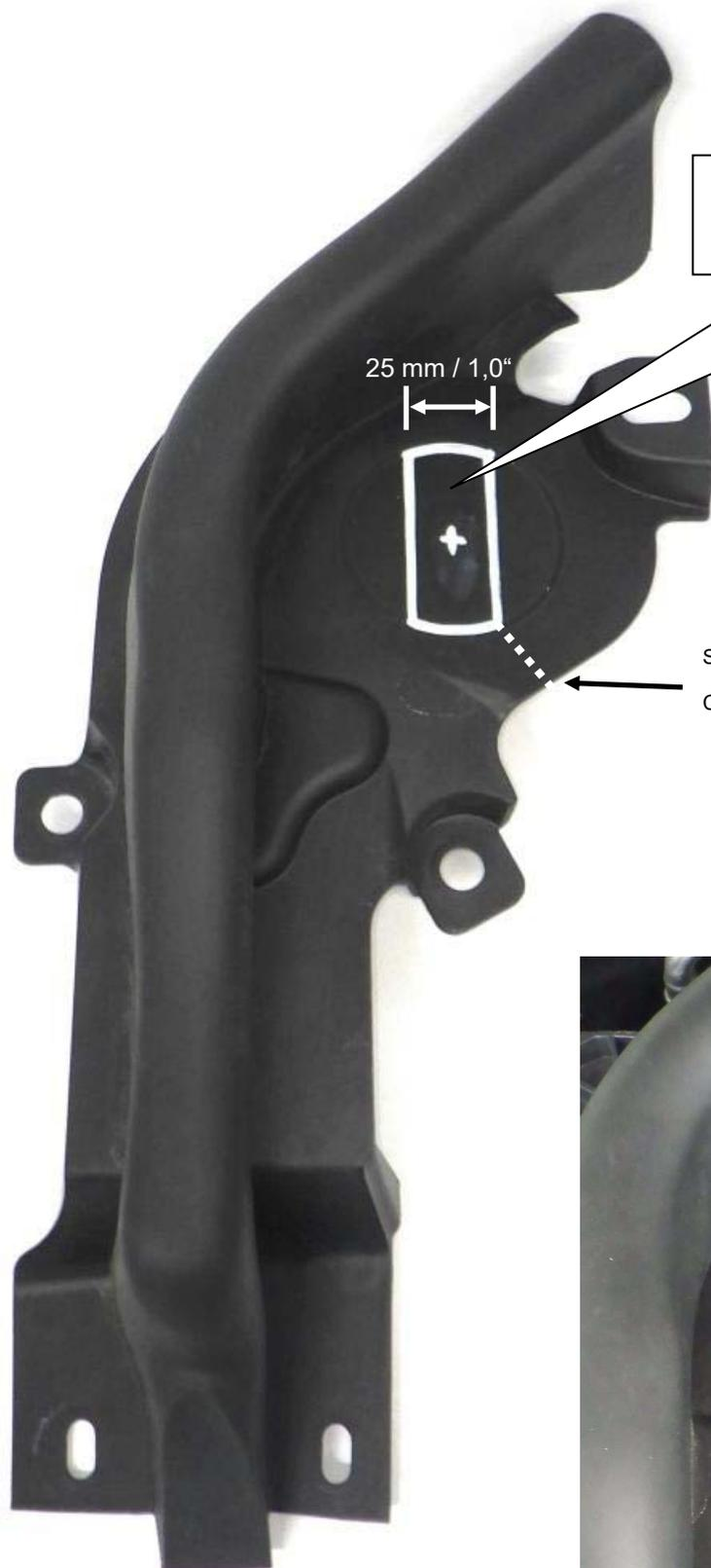
Dieser Bereich für die Durchführung der Schlauchleitung ausschneiden.
