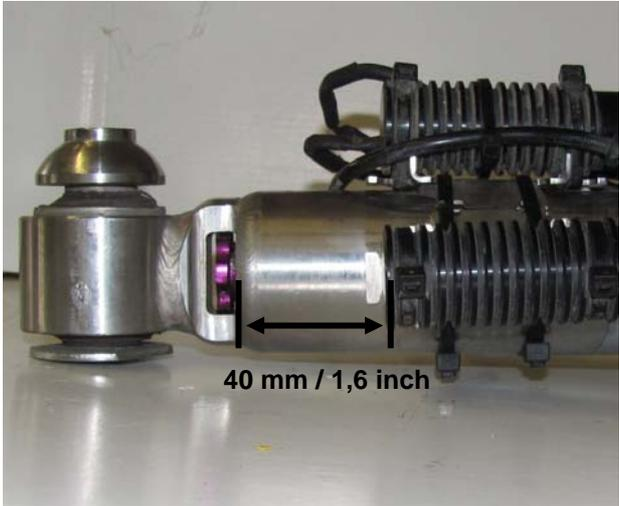
Stilllegung an der Edelstahlhalterung mit Kabelbindern 4,8mm x 290mm befestigen. Zusätzlich muss die Steckverbindung mit einem Kabelbinder an der Stilllegung befestigt werden.
