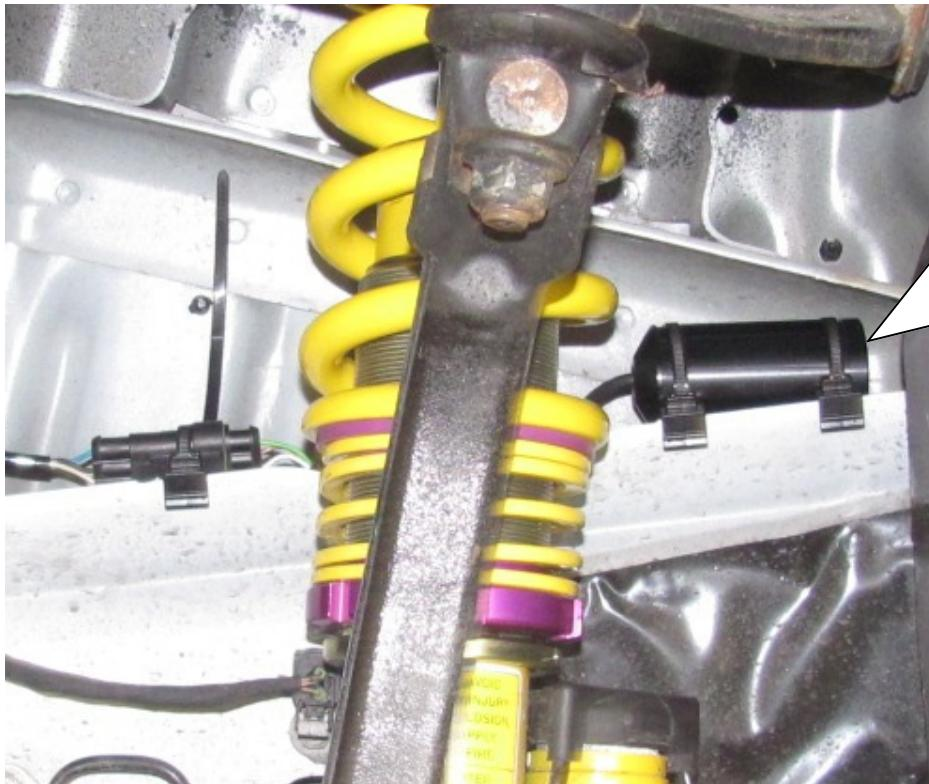
Stilllegung und Adapterkabelbaum mit den mitgelieferten Edge Clips an der Karosseriekante befestigen.
