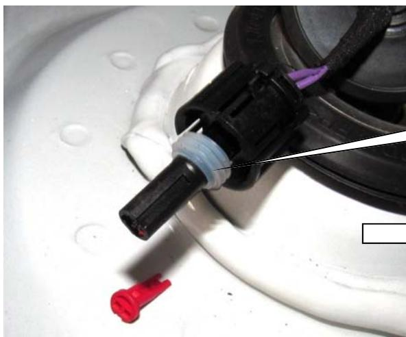
2. Rote Steckersicherung aus dem Stecker herausziehen. Original Dämpferleitung mit geeignetem Werkzeug aus der Stecker auspinnen.
