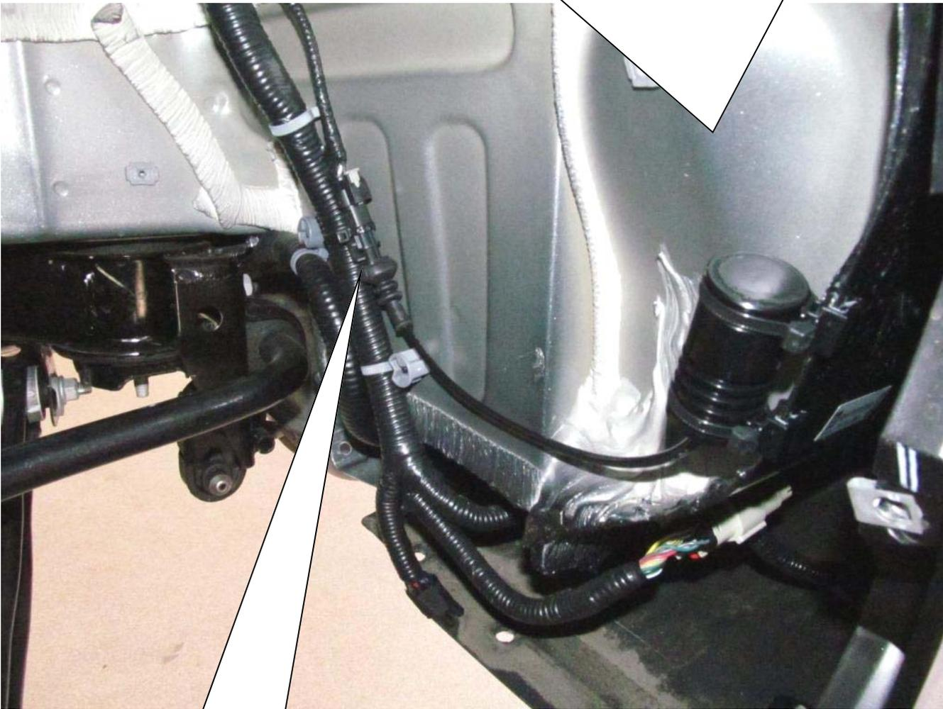
Original Kabel mit Kabelbindern befestigen.
