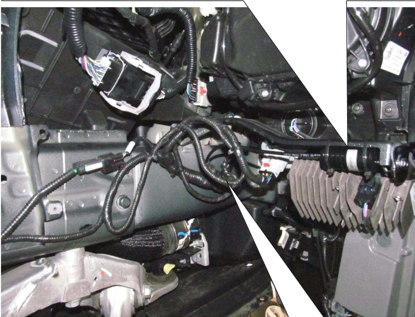
Original Kabel mit Kabelbindern befestigen.
