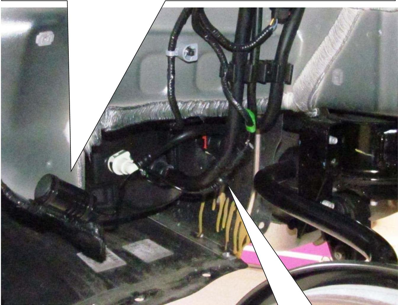
Original Kabel mit Kabelbindern befestigen.
