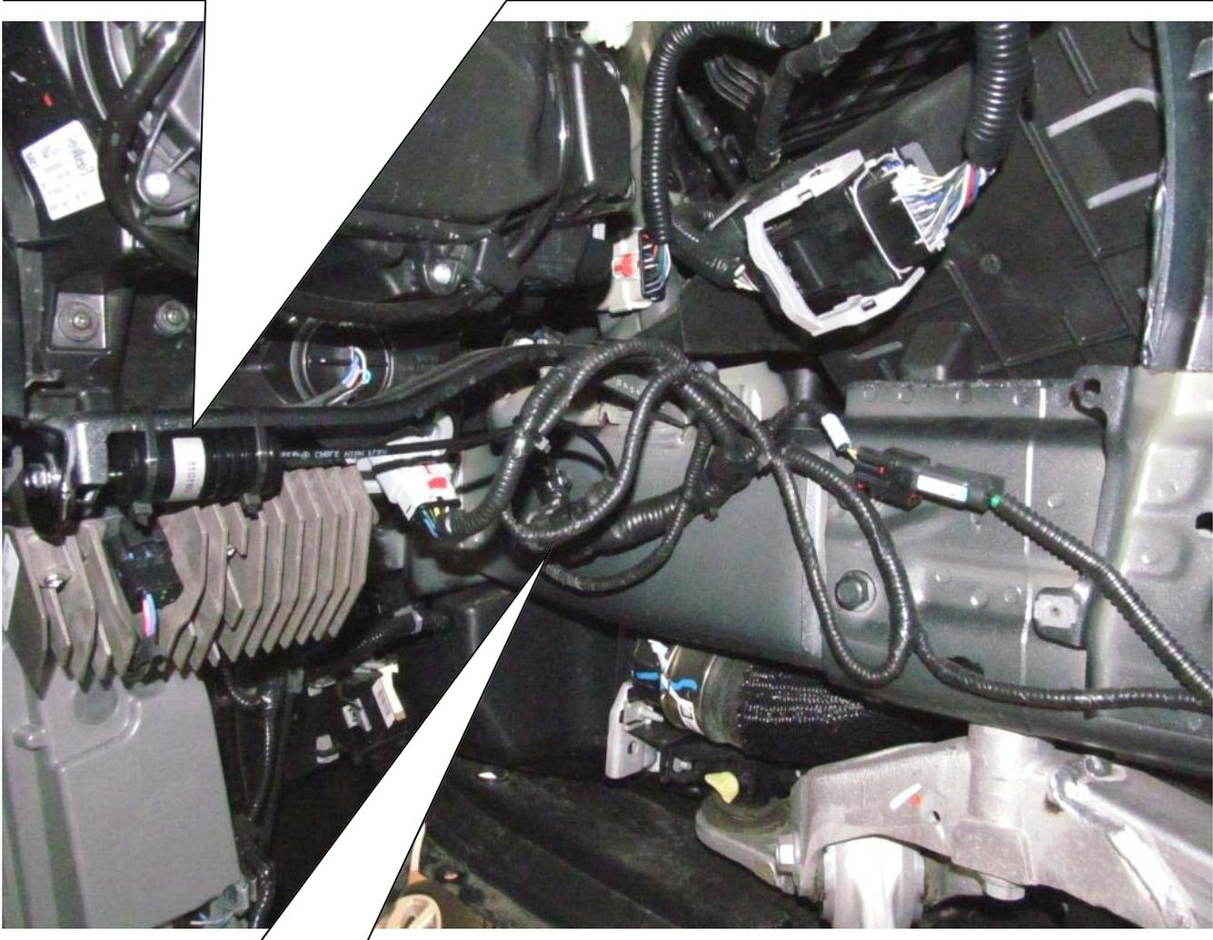
Original Kabel mit Kabelbindern befestigen.
