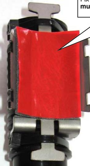
Klebeband auf den montierten Halter ankleben. **WICHTIG: Klebefläche muss Staub- und Fettfrei sein.**
