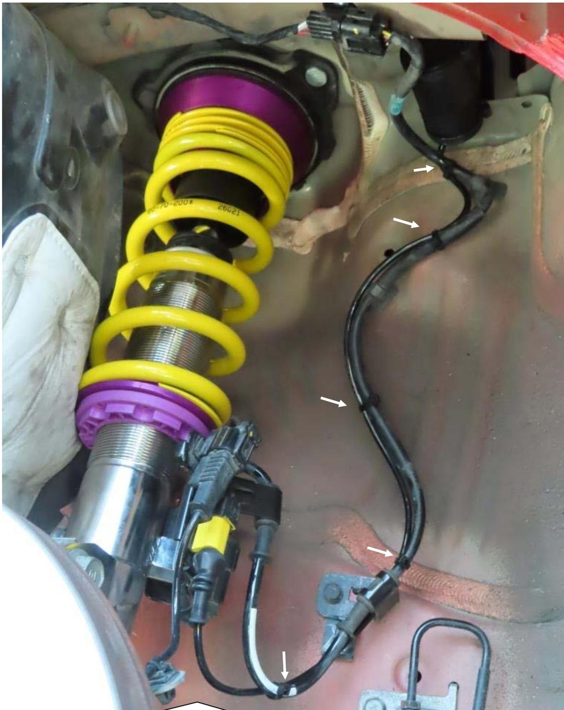
Leitung in den serienmäßigen Kabelbaum / Verteiler einstecken. Auf die korrekte Verriegelung des Steckers achten! Anschließend die Leitung mit Kabelbindern entlang der vorhandenen Leitung befestigen.
