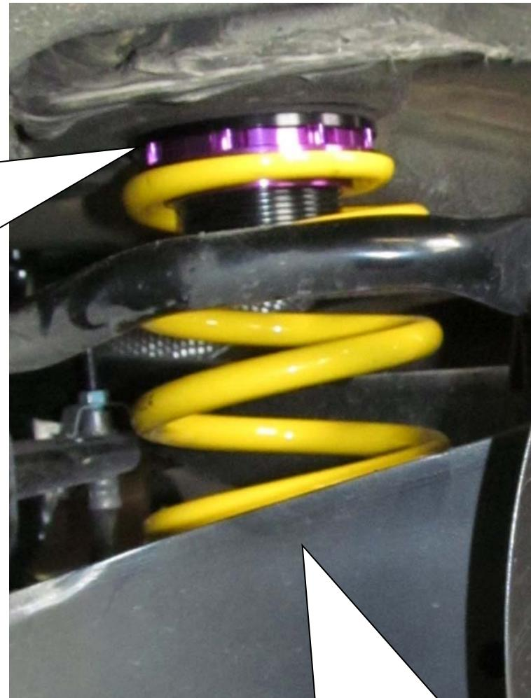
Die mitgelieferte Unterlegscheibe wird an der unteren Dämpferbefestigung montiert. Die Scheibe zeigt zur Fahrzeugginnenseite.
