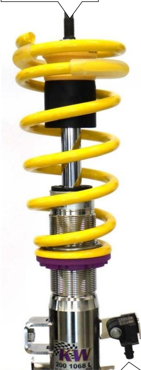
Original Beschleunigungssensor am Federbein montieren.
