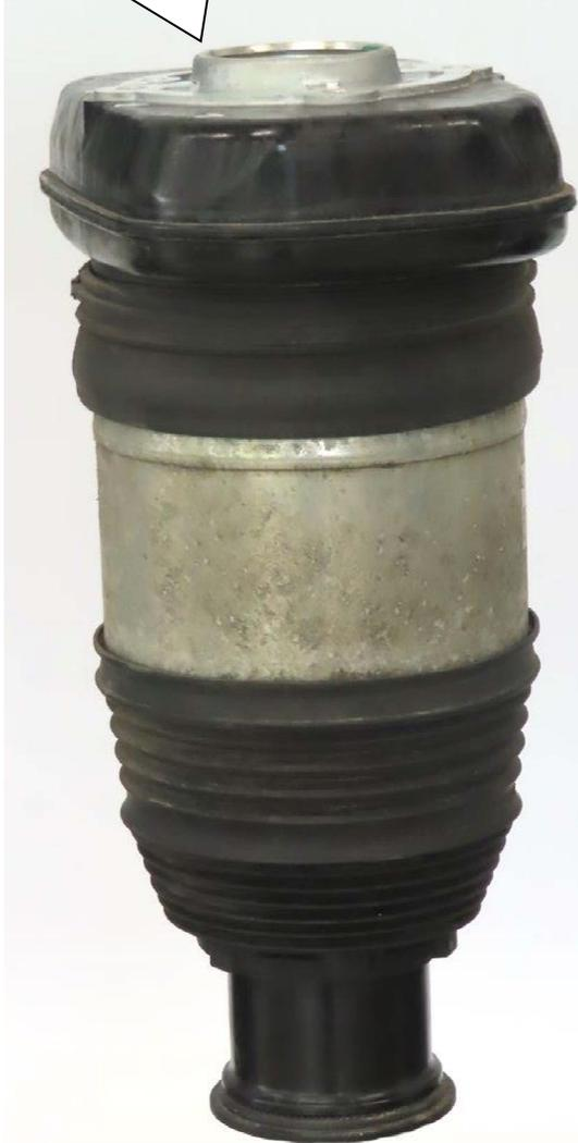
Kappe vom Dämpfer abziehen - diese wird nicht mehr benötigt.
