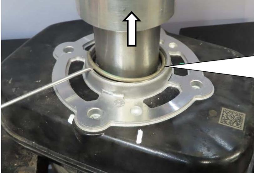
Spannring entnehmen und Presse **langsam** zurück fahren.
