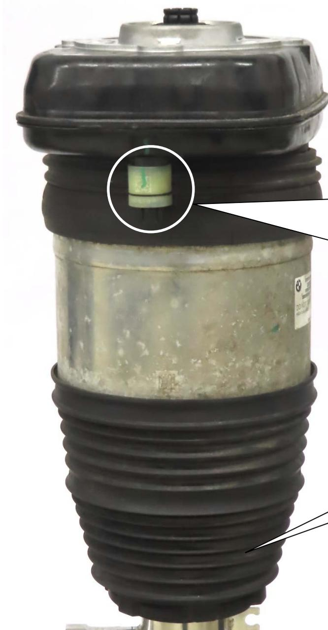
Nach der Montage des Luftbalgs muss das System manuell mit Pressluft gefüllt werden. Hierzu mit einer Pressluftpistole durch die Zuleitungsöffnung Luft einblasen.
