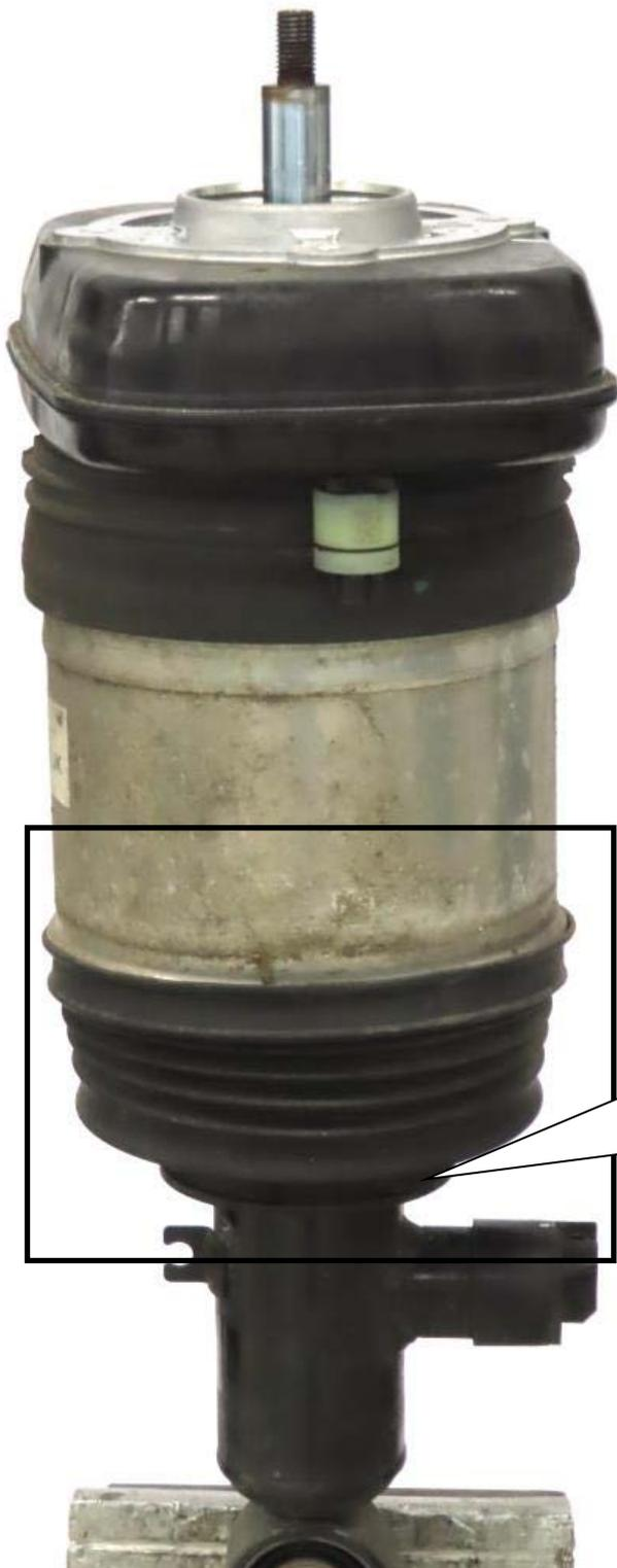
Faltenbalg an der Unterseite vom Dämpfer lösen.
