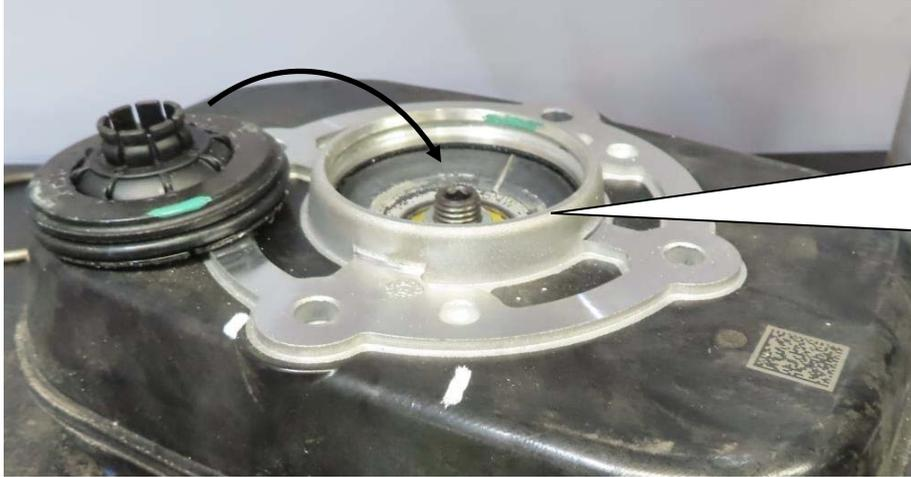
Luftfederbein mit dem Stützlager auf der Presse auflegen.
