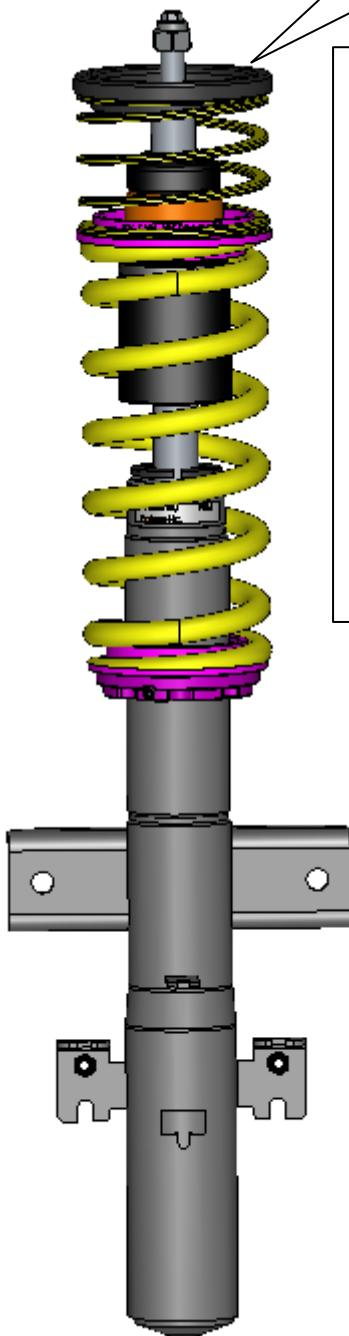
Original Stützlager aufstecken und mit der mitgelieferten Stoppmutter verschrauben. Das Anzugsdrehmoment der Kolbenstangenbefestigung beträgt 35 Nm. Die Montagehinweise zum Einbau des Federbeines in das Fahrzeug, sowie die Anzugsdrehmomente der Federbeinbefestigung, entnehmen Sie bitte den Unterlagen des Fahrzeugherstellers.
