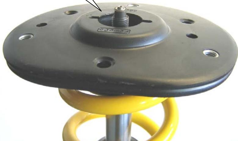
Nach erfolgtem Einbau des Fahrwerkes ist die Freigängigkeit der Bereifung zum VA-Federbein zu überprüfen. Das Mindestabstandsmaß darf an der engsten Stelle **5 mm** nicht unterschreiten und ist gegebenenfalls mittels Distanzscheiben wieder herzustellen.
