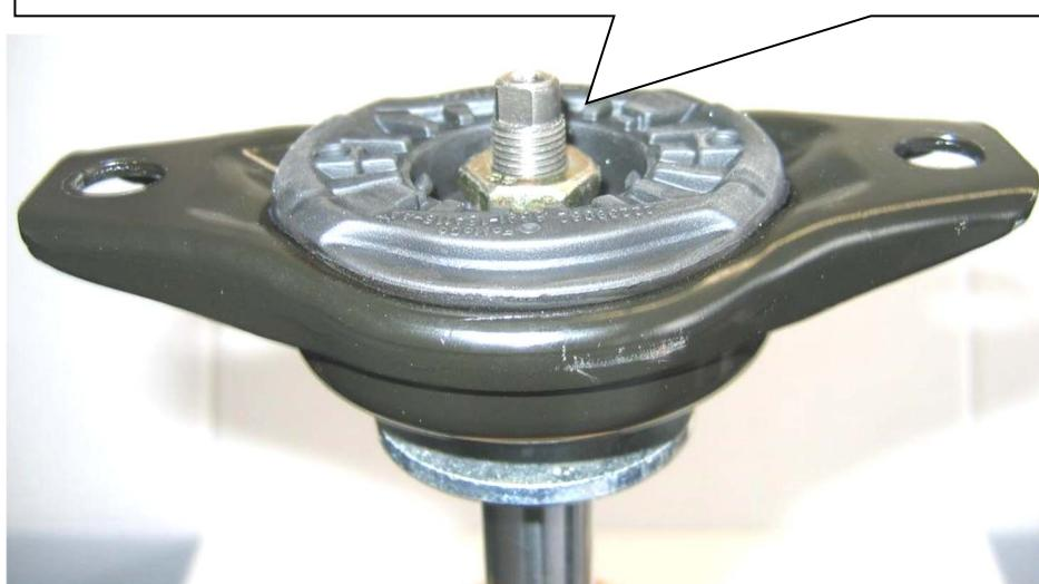
Bei der unteren Dämpferbefestigung muss die mitgelieferte Beilagscheibe eingebaut werden. Dabei darauf achten, dass die Scheibe in Richtung Fahrzeugmitte montiert wird.
