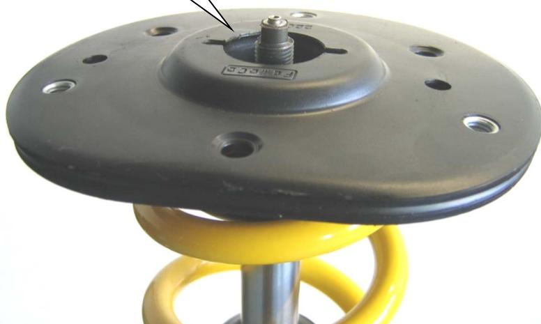
Nach erfolgtem Einbau des Fahrwerkes ist die Freigängigkeit der Bereifung zum VA-Federbein zu überprüfen.
