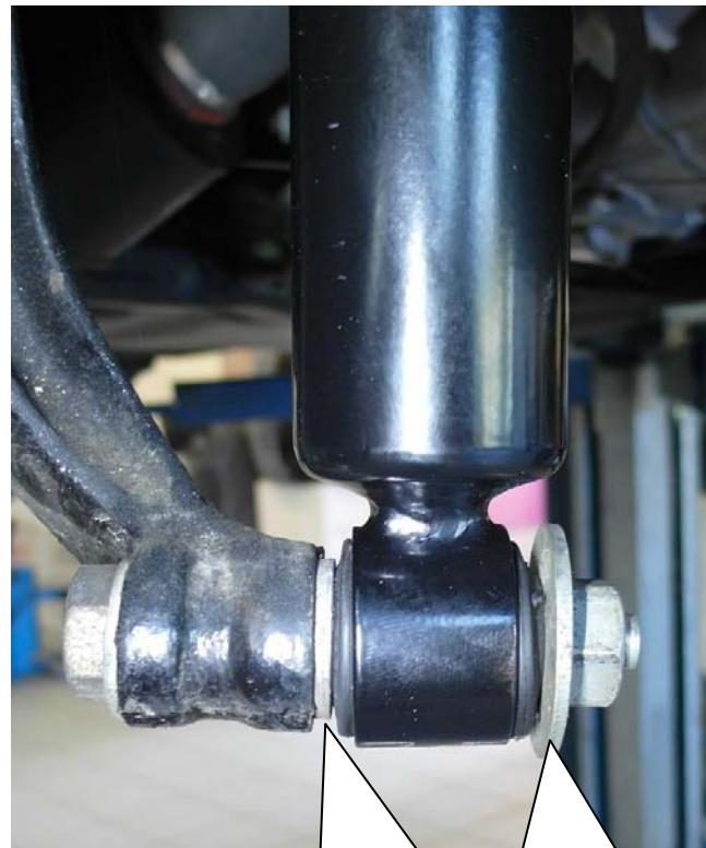
Am oberen Dämpferauge werden die mitgelieferten Unterlegscheiben montiert.
