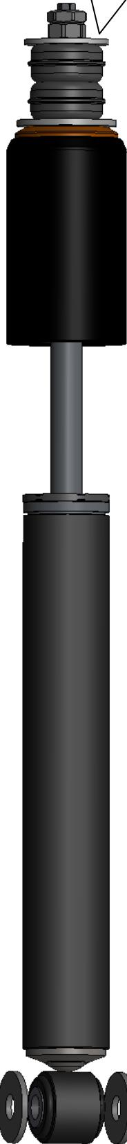
Dämpfer durch die obere Aufnahme stecken und mit den mitgelieferten Muttern verschrauben. Das Anzugsdrehmoment der Kolbenstangenbefestigung beträgt 20 Nm. Die Montagehinweise zum Einbau des Dämpfers in das Fahrzeug, sowie die Anzugsdrehmomente der unteren Befestigung, entnehmen Sie bitte den Unterlagen des Fahrzeugherstellers.
