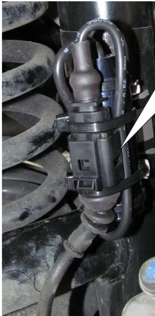
Stecker der Stilllegung in den Original Stecker einstecken. Auf die korrekte Verriegelung des Steckers achten! Anschließend originale Dämpfersteuerungsleitung mit Kabelbindern befestigen.
