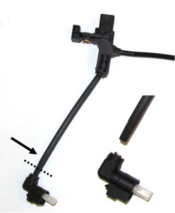
2. 15 mm von der Ummantelung der Leitung entfernen und die Adern 4 - 5 mm abisolieren. Anschließend den mitgelieferten Knickschutz auf die Leitung aufstecken.
