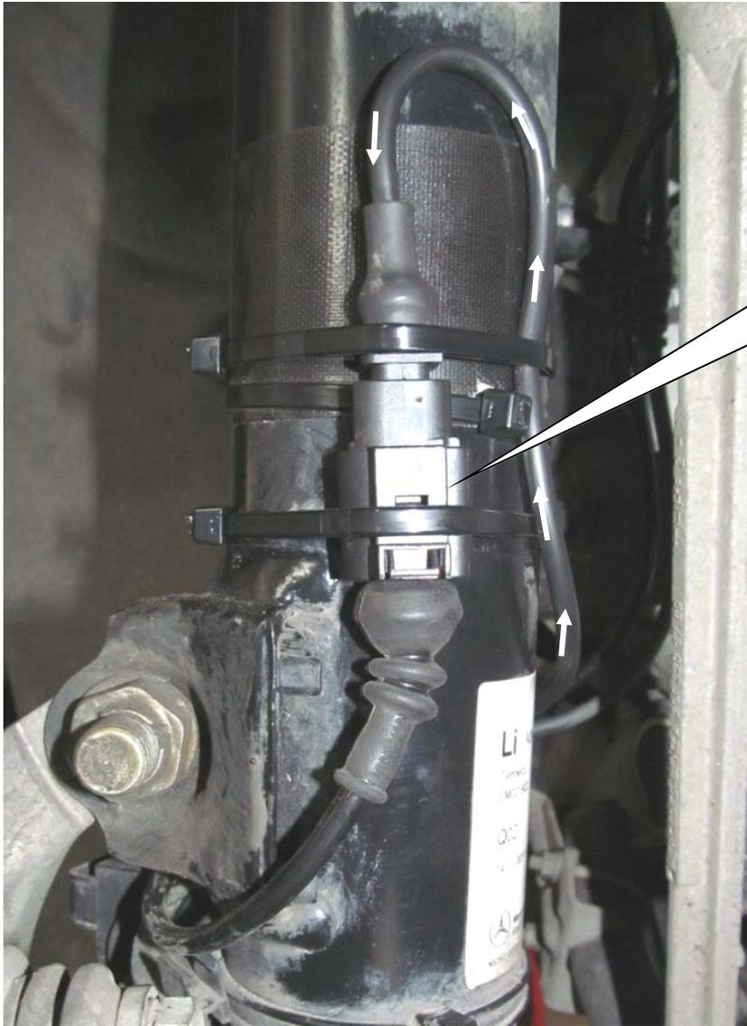
Stecker der Stilllegung in den Original Stecker einstecken. Auf die korrekte Verriegelung des Steckers achten! Anschließend die neue Leitung mit Kabelbindern befestigen.
