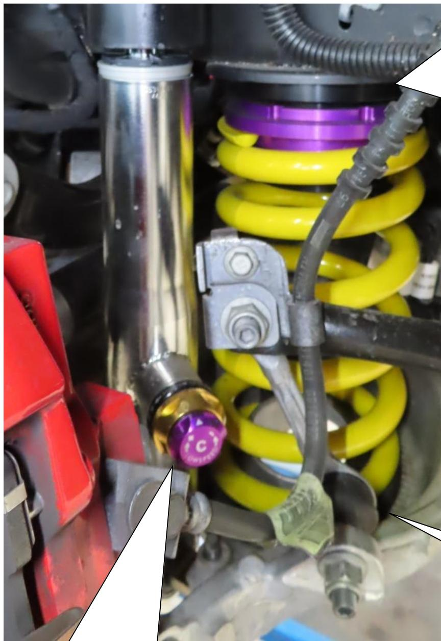
Die Druckstufeneinstellung muss zur Fahrzeugheckseite außen zeigen.
