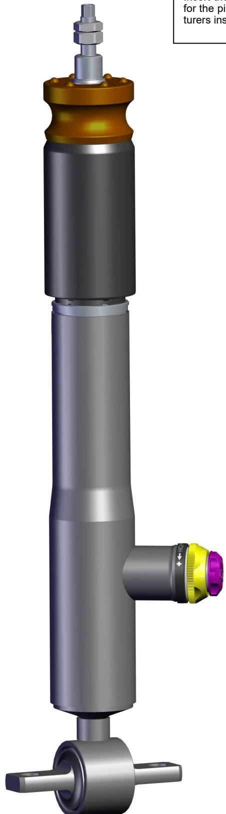
Original Stützlager aufstecken und mit den mitgelieferten Muttern verschrauben. Das Anzugsdrehmoment der Kolbenstangenbefestigung beträgt 20 Nm. Die Montagehinweise zum Einbau des Dämpfers in das Fahrzeug, sowie die Anzugsdrehmomente der unteren Dämpferbefestigung entnehmen Sie bitte den Unterlagen des Fahrzeugherstellers.
