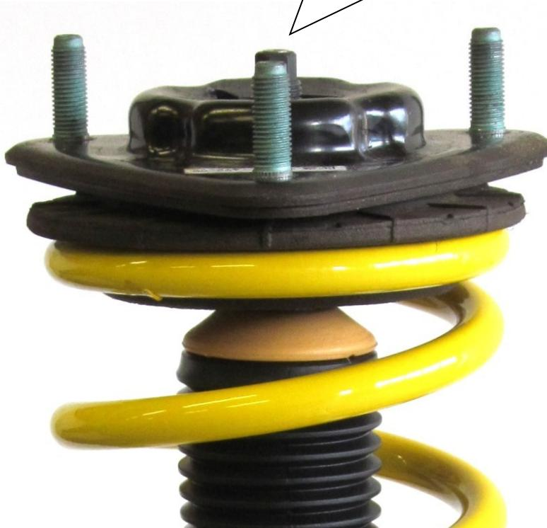
Nach erfolgtem Einbau des Fahrwerkes ist die Freigängigkeit der Bereifung zum VA-Federbein zu überprüfen. Das Mindestabstandsmaß darf an der engsten Stelle **5 mm** nicht unterschreiten und ist gegebenenfalls mittels Distanzscheiben wieder herzustellen.
