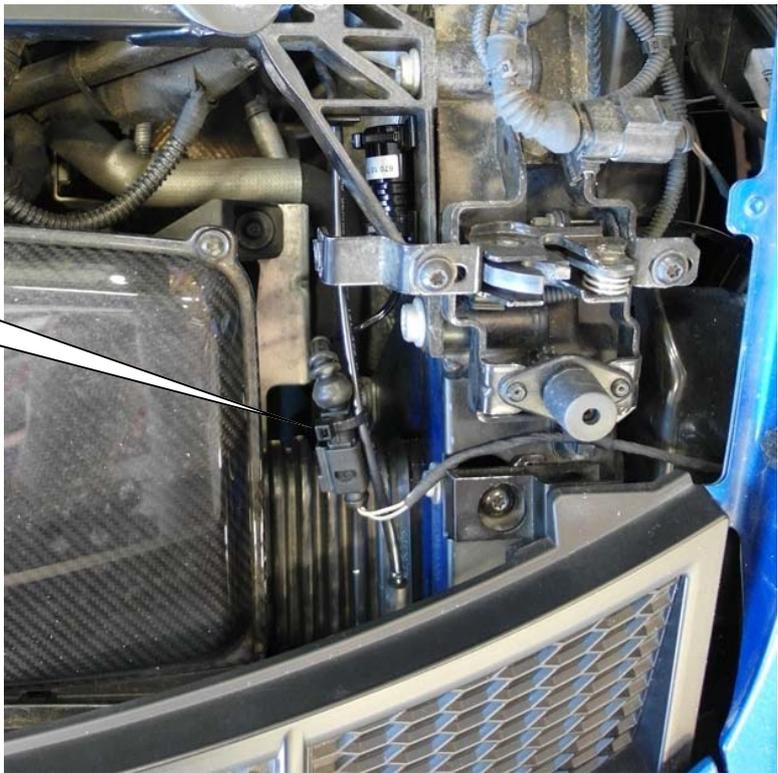
Stilllegung mit den mitgelieferten Edge Clips an der Karosseriekante befestigen. Leitung mit Kabelbindern befestigen.
